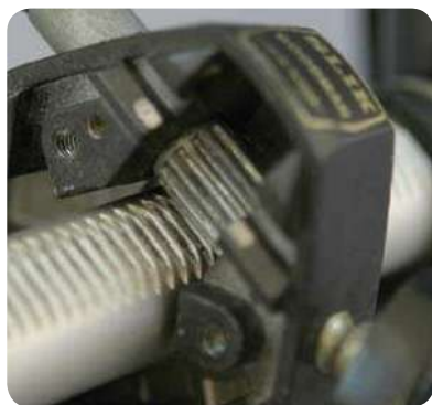
圆形齿条的上面可以看到小齿轮
